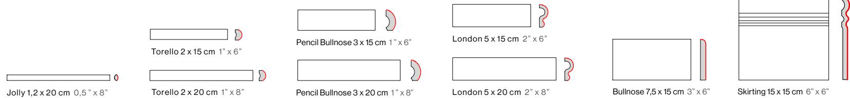
La línea roja indica la superficie esmaltada / The glazed surface is indicated by a red line / Die rote Linie zeigt die glasierte Fläche an / La ligne rouge indique la surface émaillée.
