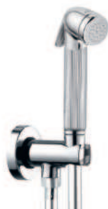
C69006 Kit doccia a pulsante idrogetto Nikita in ottone, presa acqua con valvola di sicurezza, flessibile Cromolux.
