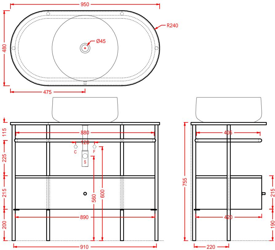
Le staffe di sostegno inferiori sono strutturali, servono per il montaggio del cassettone, sono da rimuovere se sceglie di installare la griglia
